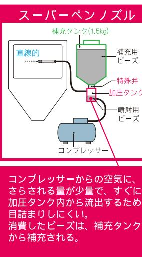
コンプレッサーからの空気には、さらされる量が少量で、すぐに加圧タンク内から流出するため目詰まりしにくい。消費したビーズは、補充タンクから補充される。
