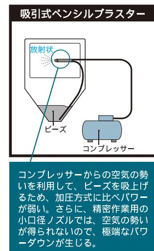
コンプレッサーからの空気の勢いを利用して、ビーズを吸上げるため、加圧方式に比べパワーが弱い。さらに、精密作業用の小口径ノズルでは、空気の勢いが得られないで、極端なパワーダウンが生じる。
