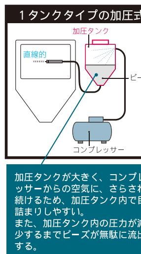
加圧タンクが大きく、コンプレッサーからの空気には、さらされる量が多いため、加圧タンク内で目詰まりしやすい。また、加圧タンク内の圧力が減少するまでビーズが無駄に流出する。
